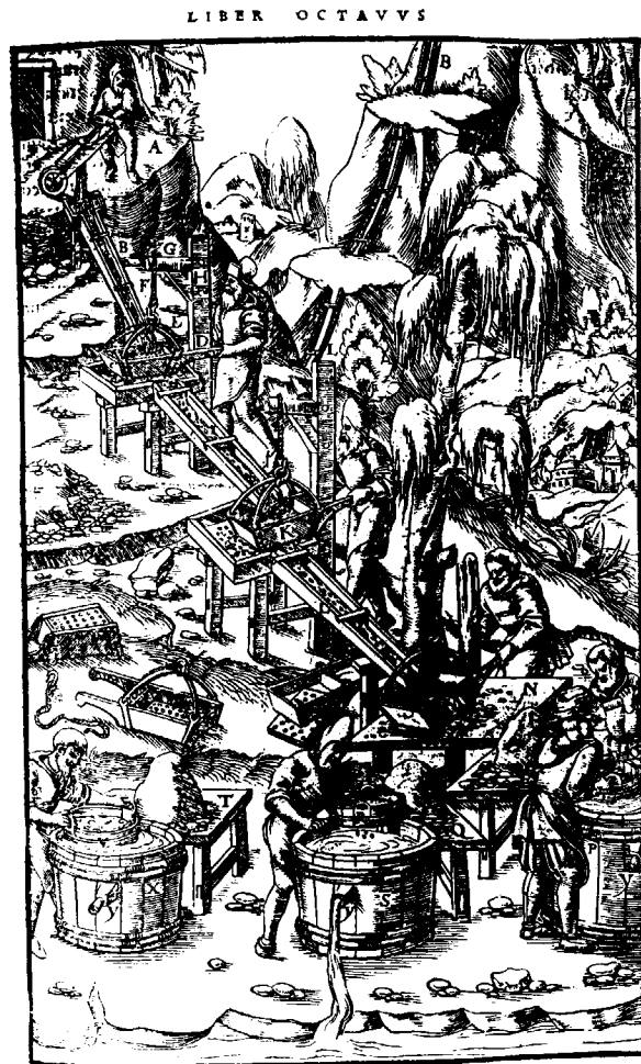
Figura 4.—Lavado de minerales con canales (De Re Metallica, 1556).
